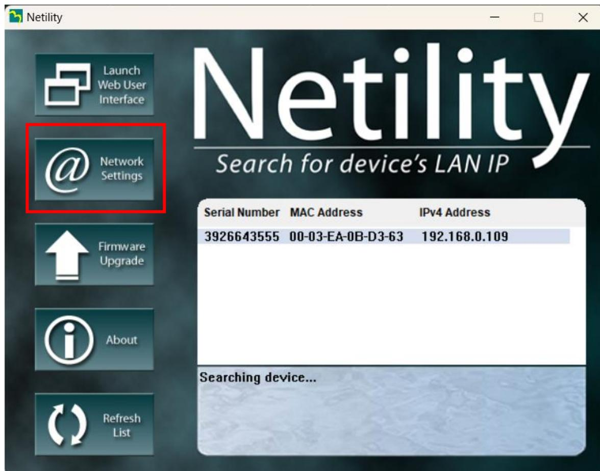
Por defecto la tarjeta viene en modo **DHCP** (asignamiento automático de IP), para asignar una dirección estática se debe presionar el botón “**Network Settings**”
