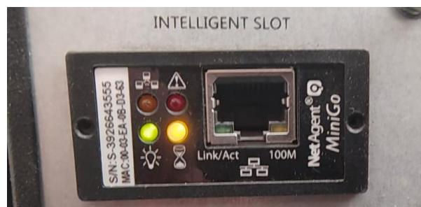
**Nota:** La tarjeta SNMP es tecnología Hot Swap, por tanto, no se requiere de apagar ni la carga conectada.
